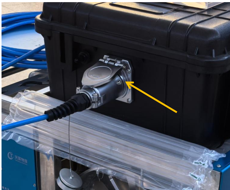
图1-4 连接电源箱与总成开关
