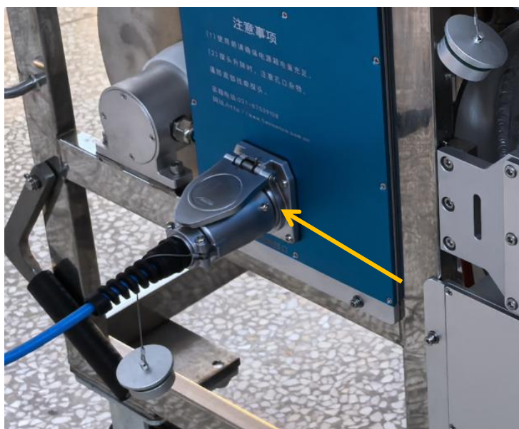
图1-5 连接总成开关与全自动绞车
