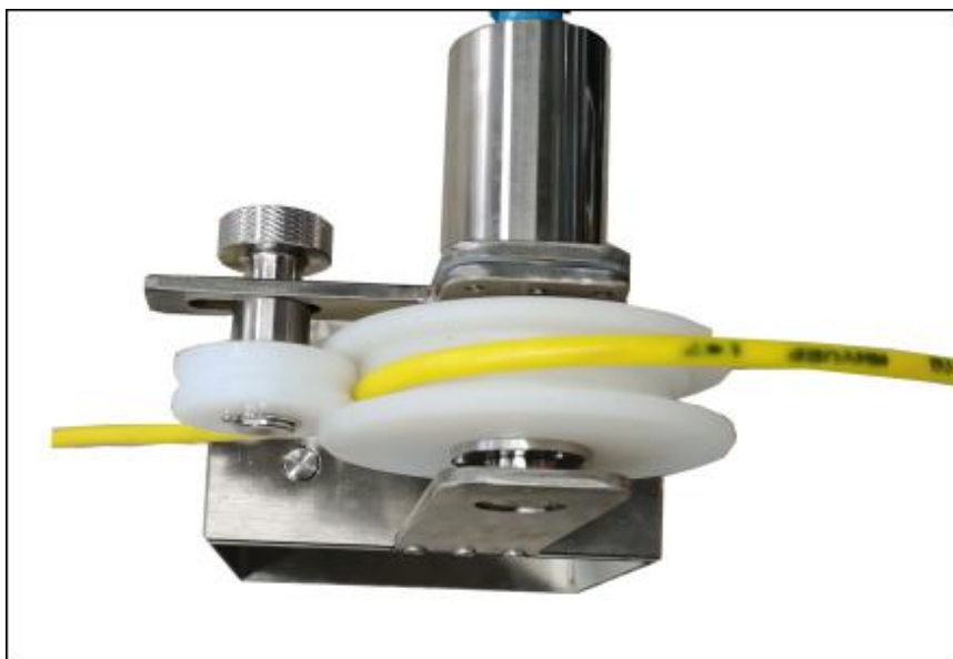
图2-2 安装深度计数器
