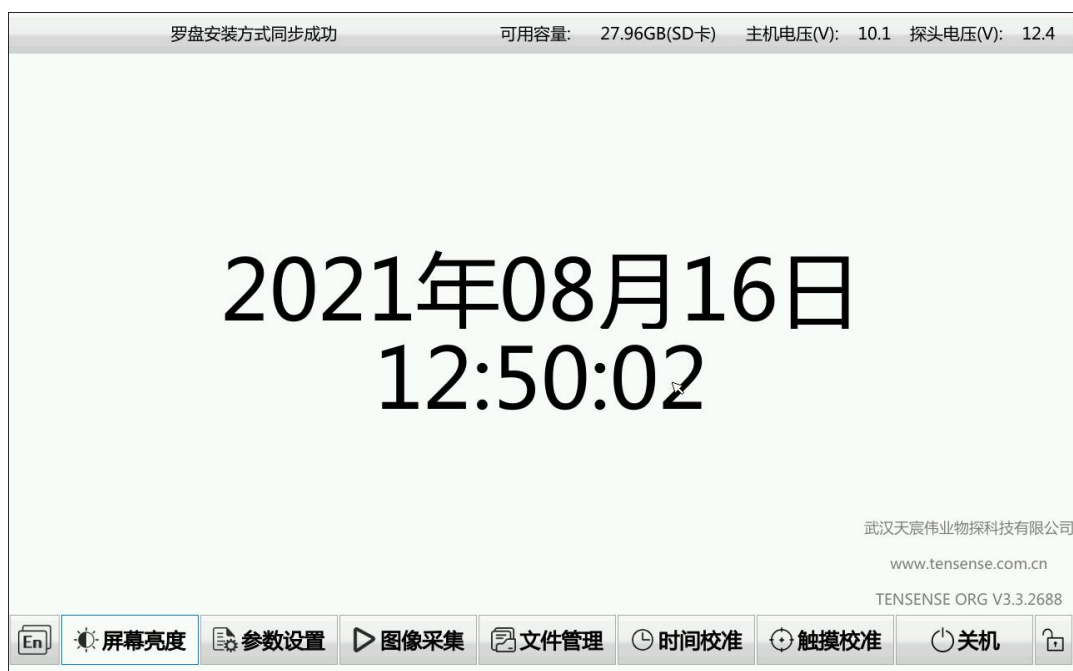
图2-4 电压与存储空间检查界面
