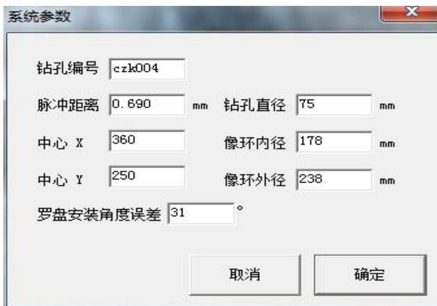
图3-3 在系统参数中修改脉冲间距
