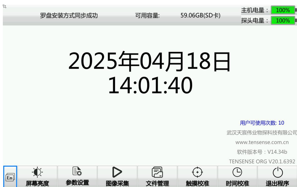
图2-4 电压与存储空间检查界面
