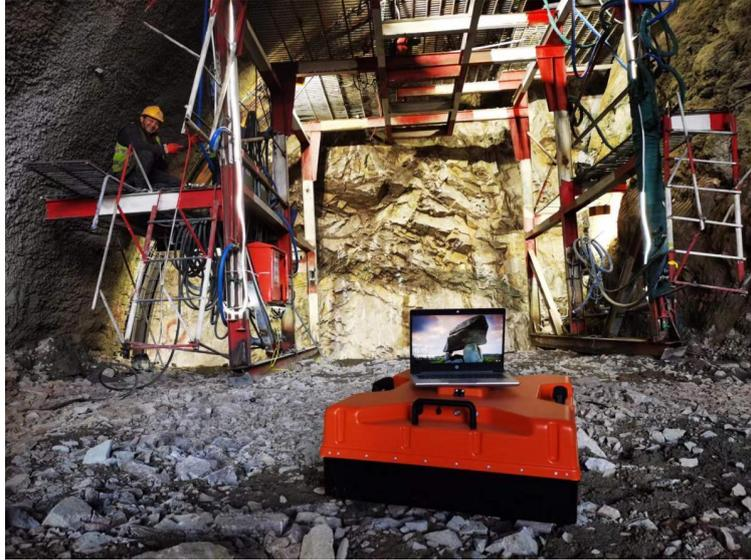
在掌子面上沿水平方向共布置了 1 条地质雷达测线，左右各一次，测线布置情况据图如下图所示：
