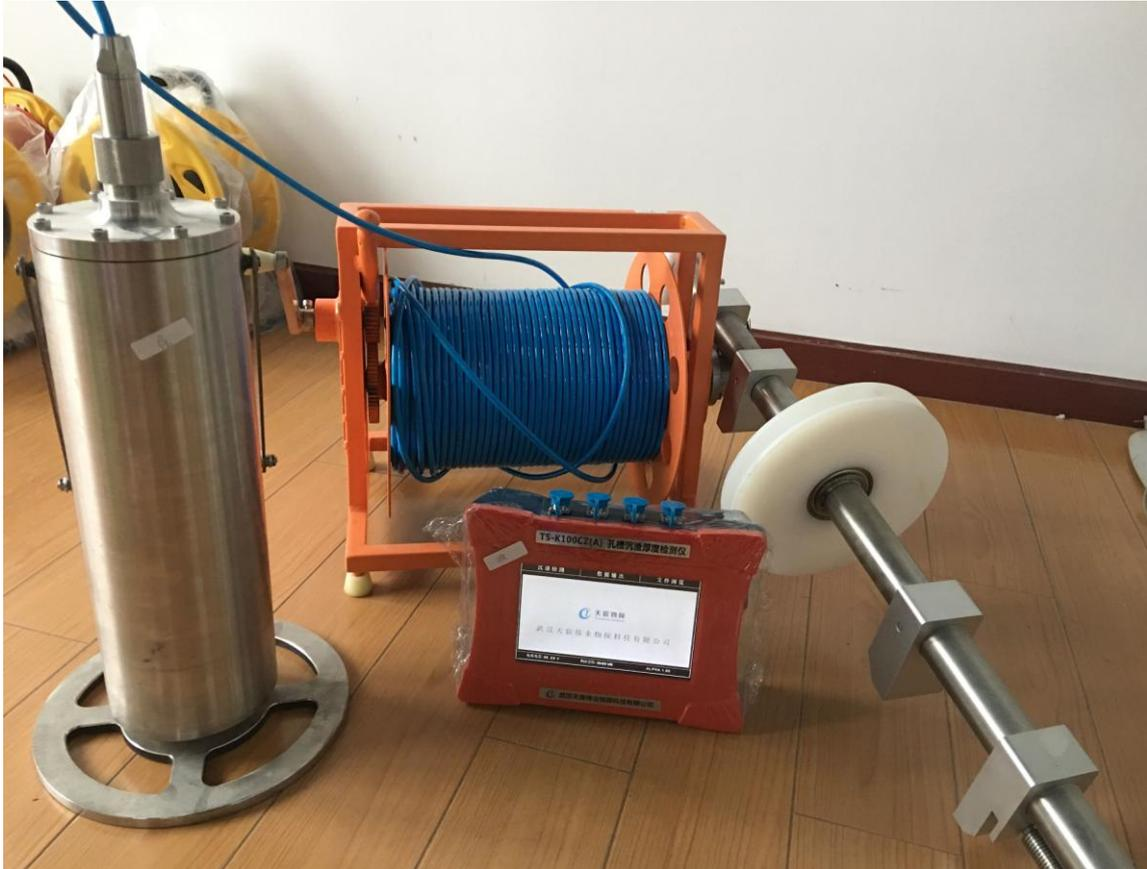
图 1-1 孔槽沉渣厚度检测仪
