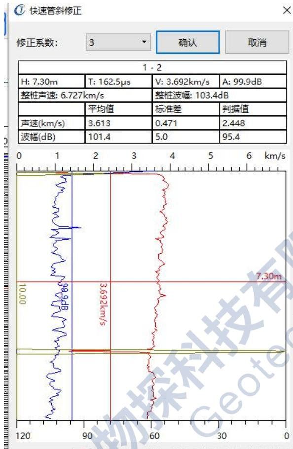
图3-13快速管斜修正界面
