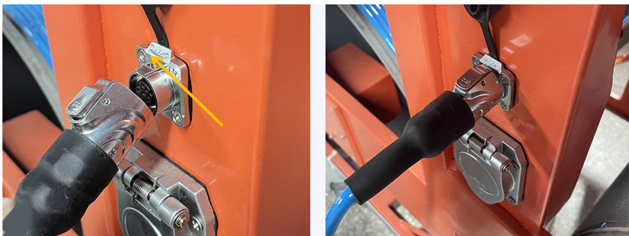
图1-6 连接8芯信号航插
