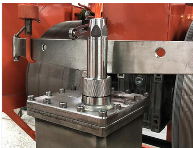
图1-8 探头与电缆环氧头
