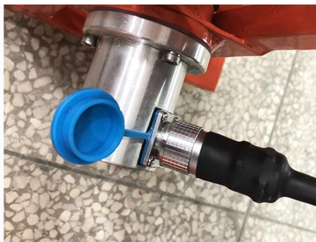
图1-6 连接8芯信号航插
