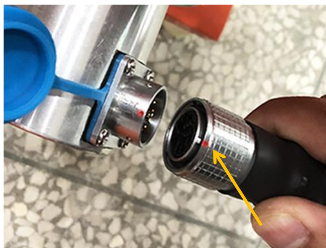
图1-6 连接8芯信号航插
